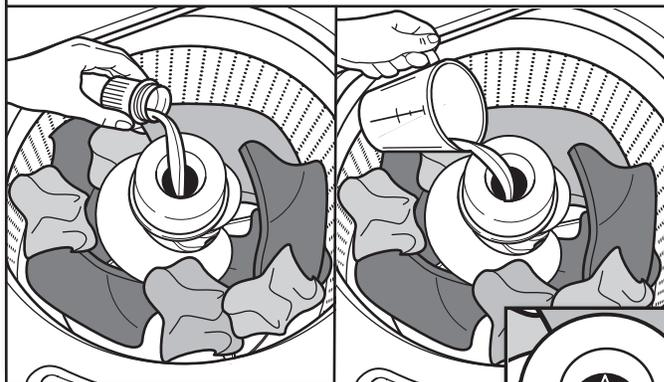
Verser une mesure d'assouplissant pour tissu liquide dans le distributeur – toujours suivre les instructions du fabricant concernant la dose d'assouplissant pour tissu à utiliser en fonction de la taille de la charge.
