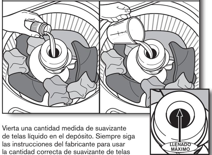
Vierta una cantidad medida de suavizante de telas líquido en el depósito. Siempre siga las instrucciones del fabricante para usar la cantidad correcta de suavizante de telas según el tamaño de la carga.
