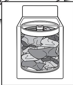
**IMPORTANT :** Ne pas tasser les articles ou les pousser dans le lave-linge. Les articles doivent pouvoir se déplacer librement pour un nettoyage optimal et pour réduire le froissement et l'emmêlement. Charger les articles plus lourds d'abord. Ne pas charger au-delà du système d'agitation. Ne pas charger de vêtements par-dessus du bas de l'anneau intérieur blanc.
