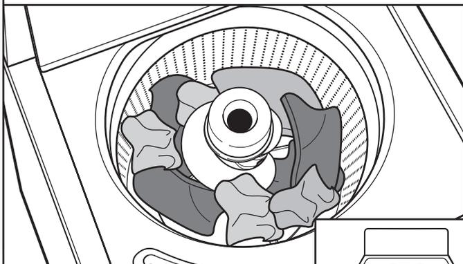
Caricare gli indumenti sciolti in modo uniforme intorno alle pareti del cestello. Per ottenere i migliori risultati non compattare il carico. La dimensione massima di carico (testata) è 7,7 kg. Non avvolgere capi di grandi dimensioni, ad esempio lenzuola intorno all'agitatore; caricarli in pile sciolti intorno ai lati del cestello. Cercare di mescolare diversi tipi di capi per ridurre i grovigli.
