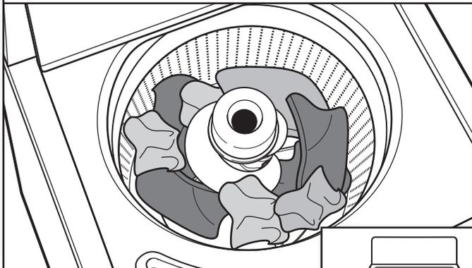
Charger les vêtements sans les tasser et de façon uniforme le long de la paroi du panier. Pour de meilleurs résultats, ne pas tasser la charge. La taille de charge maximale (testée) est de 7,7 kg. Ne pas enrouler de grands articles tels des draps autour de l'agitateur; les charger sans les tasser le long de la paroi du panier. Essayer de mélanger des articles de différentes tailles pour réduire l'emmêlement.
