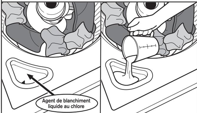
Ne pas remplir excessivement le distributeur, ni diluer, ni utiliser plus de 250 mL (une tasse) d'agent de blanchiment liquide au chlore. Ne pas utiliser d'agent de blanchiment sans danger pour les couleurs ni de produit Oxi avec un programme utilisant de l'agent de blanchiment au chlore liquide.
